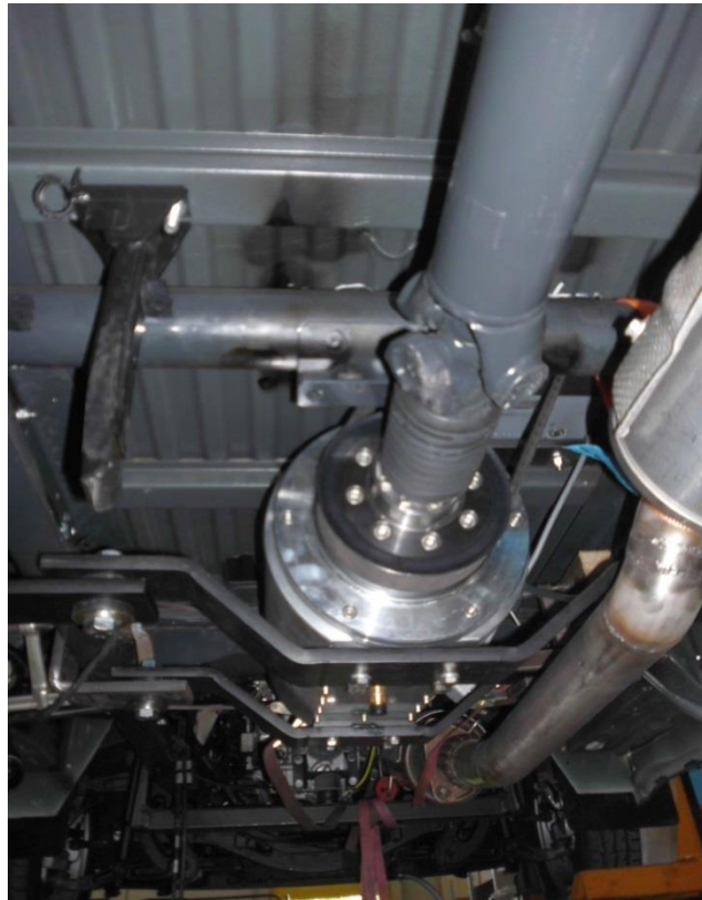
Leistungsverzweigungsgetriebe Taurus mit Direktantrieb über Zahnriemen
