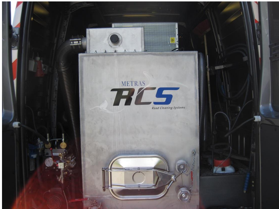
Edelstahl Wassertank - Tank in Tanksystem 900 Liter Frischwasser und 1.000 Liter Brauchwasser
